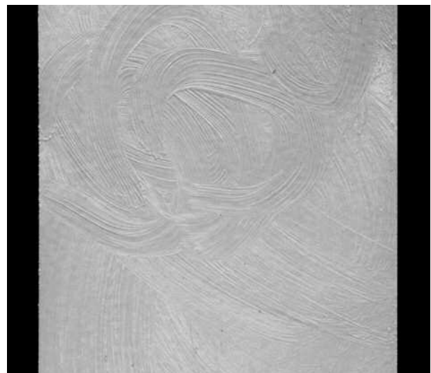
Schlierenbildung durch ungleichmäßige Verteilung eines Reinigers vom Typ II. (Bild 3.2)
