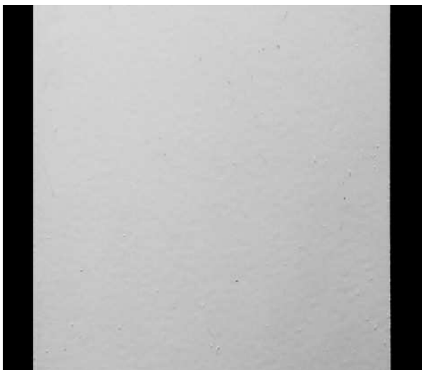
Einwandfrei mit einem Reiniger vom Typ II behandelte Oberfläche. (Bild 3.1)
