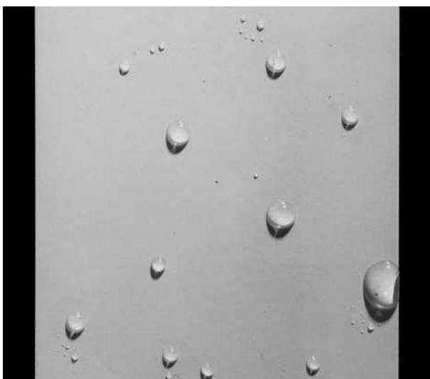
Gut wasserabweisende Oberfläche mit geringer Benetzung nach Anwendung eines Reinigers Typ I b bzw. II. (Bild 2.1)
